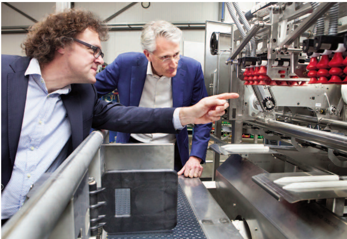
Eelco Post (links) en Michiel Peters bij een van de 'oude' loaders van Moba. De unit met (bruinrode) zuignappen voor het oppakken van de eieren, is een 'cherry' die in de nieuwe, modulaire loader zal terugkeren. Foto: Maarten Hartman
